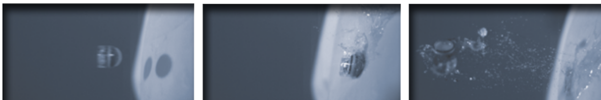
Auswirkungen des Auftreffens eines FN 303-Wuchtgeschosses auf einen anthropomorphen Testkörper (ATD) aus Polyvinyl
