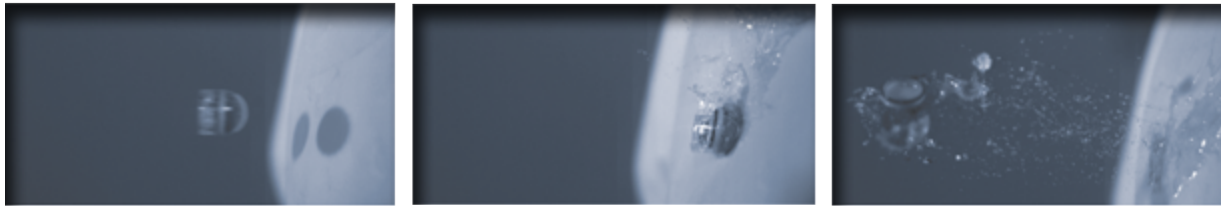
Impact d'un projectile FN 303® sur un torse d'essai anthropomorphique (ATD) en polyvinyle
