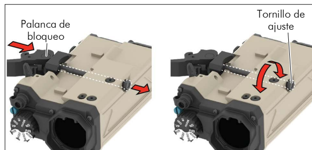
Fig. 6.f - Giro del tornillo de ajuste para variar la presión de agarre
