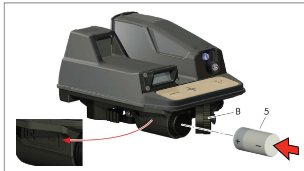
Fig. 3.i - Instalación de la pila en la FN® FCU Mk3
