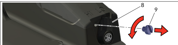
Fig. 3.l - Réglage du sélecteur de puissance du pointeur en position HI
