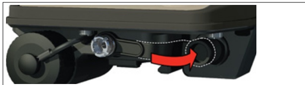
Fig. A.d - Placement du capuchon de protection
