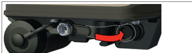
Fig. A.d - Instale el tapón de protección
